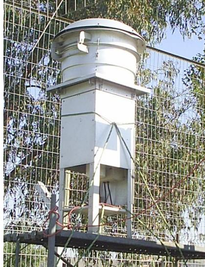
**Figura 3-10 Muestreador de alto volumen instalado en Rancagua**
